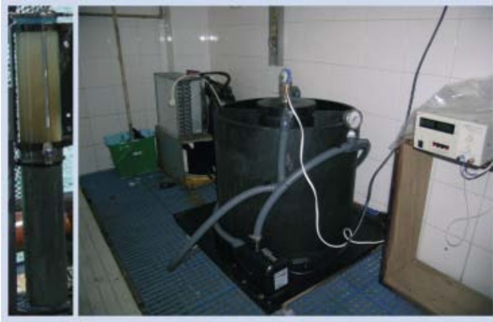
Foto 2 Izada: corer con perfil de sedimento marino; Dcha.: incubador con enfriador y fuente de alimentación para la agitación.
