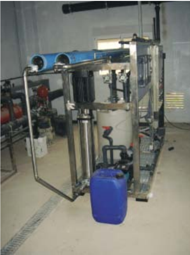
Foto 1 Planta piloto de desalación de aguas salobres por ósmosis inversa, capaz de producir 18 m 3 /día de agua desalada.
