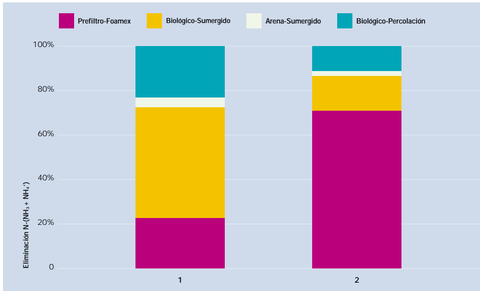
Figura 3 Contribución al amoníaco eliminado por parte de los elementos de filtración. Valores expresados como porcentaje respecto del total eliminado, en términos absolutos (1) y por unidad de material filtrante (2).
