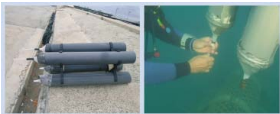
Foto 3 Izqda: trampas de sedimentación; Dcha: recogida de muestras en las trampas de sedimentación.
