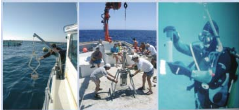
Foto 1 Izqda: draga Van Veen; Centro: draga box-corer; Dcha: corer buceo.
