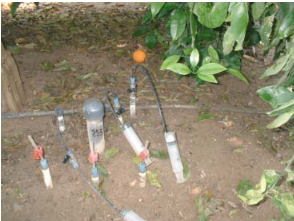
Figura 1 Bateria de sondas de succión con tres tipos de cierres en cultivo de cítricos en riego localizado.
