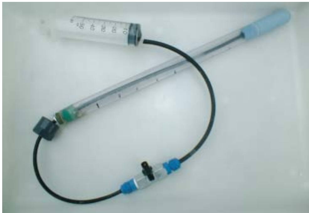
Figura 2 Detalle de sonda de succión equipada con un cierre tipo B, de tapón roscado.
